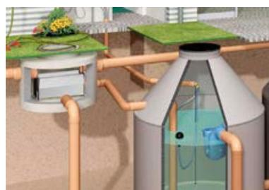
Die Regenrückhaltebecken sind zur Rückhaltung größerer Regenmengen ausgelegt.
