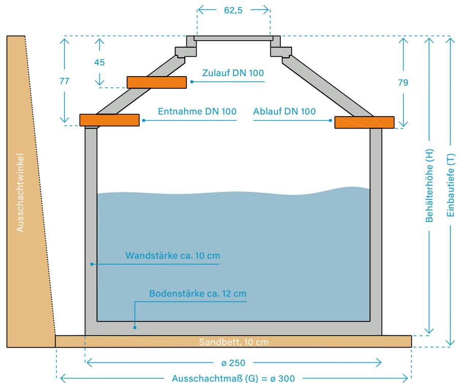
**Hinweis:** Bei allen Modellen verändern sich die Behälterhöhen (H) und damit die Ausschachtmaße sowie die Höhen für Einlauf, Ablauf und Versorgungsrohr zur Pumpe: bei Abdeckung 12,5 t um 5 cm und bei Abdeckung 40,0 t um 8 cm.
