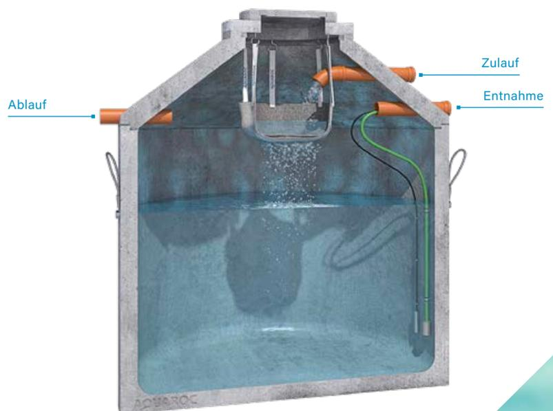
**Modell N:** Der Aquaroc Hydrophant besteht aus einem monolithischen Unterteil und einem Konus aus Stahlbeton und ist werkseitig fix und fertig vermörtelt. Alle Anschlussrohre sind werkseitig eingebaut.
